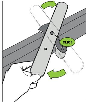
Faire pivoter le pied escamotable perpendiculairement à l'enrouleur, jusqu'au clic.
