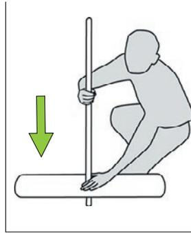
Positionner le mât télescopique sur la base.
